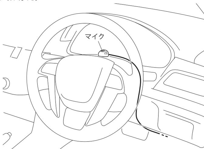
※ 取り付けの際は、市販のコードクリップ等でコードを固定し、運転操作に支障のないように取り付けてください。
