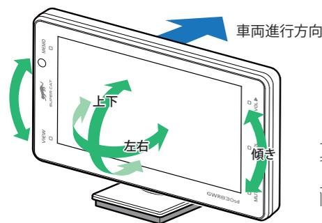
**7** Gセンサーやジャイロセンサーが正しく動作するように、本機の背面が車両進行方向を向くようにし、画面が見やすいように調整してください。
