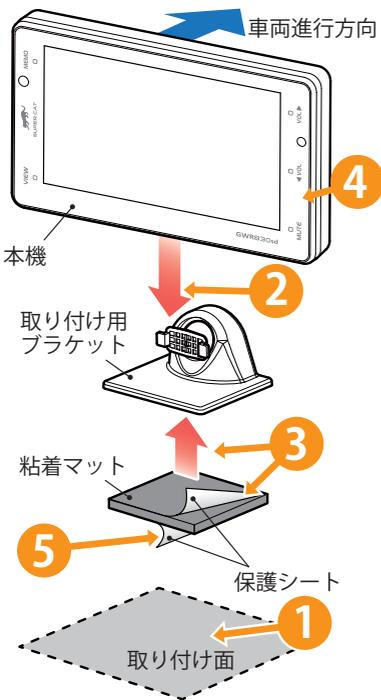
**1** ダッシュボードの取り付け面にホコリや汚れがないことを確認してください。取り付け面は、なるべく平らで水平に近く、GPS電波を受信しやすい場所にしてください。
