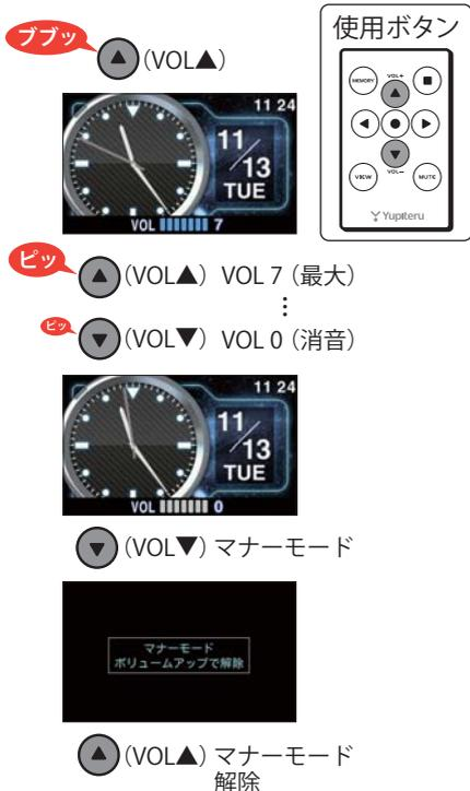
本機の[VOL▲]、[VOL▼]ボタンタッチ、またはリモコンの[▲]、[▼]ボタンで音量を調整できます。『ピッ』という確認音で音量を確認してください。
