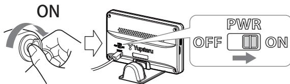
**1** エンジンキーをONにし、本機の電源スイッチを『ON』にしてください。
