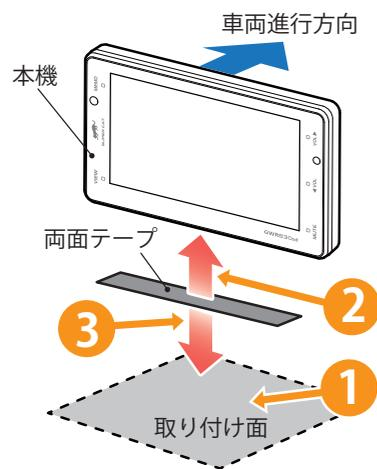
**1** ダッシュボードの取り付け面にホコリ、汚れや脂分がないことを確認してください。取り付け面は、なるべく平らで水平に近く、GPS電波を受信しやすい場所にしてください。
