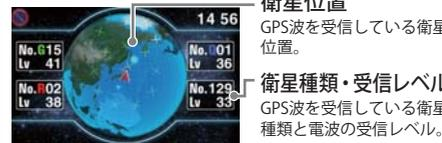
衛星位置 GPS波を受信している衛星の位置。
