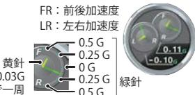
(付加情報表示: ①最大前進加速度 [MAXFWD]、②最大左右加速度 [MAXL/R])
