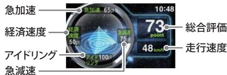
エコドライブモニター(特許出願中)を表示します。GPSの電波を受信して得られる速度データをもとに、「急加速のポイント」、「急減速のポイント」、「アイドリングのポイント」、「経済速度のポイント」の4項目から運転を総合評価します。
