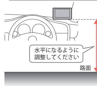
**②直付け用両面テープでダッシュボードに直接取り付ける**
