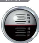
前後左右 30° の車両の傾斜を、玉の動きで表示します。車両の回頭運動を検出しているとき、一定時間玉の中に車が出現します。
