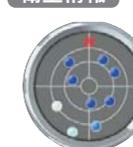
GPS 衛星の受信状態を表示します。受信レベルにより色が4色に変わります。周期的に衛星番号を表示します。
