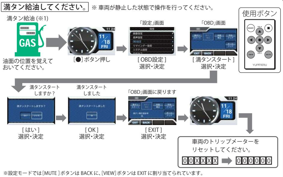
(※1): 燃料タンクの構造により給油停止後に油面が低下します。燃料の油面低下が止まった位置を覚えておいてください。(車両によっては下がり方が遅く、また低下が大きい場合があります。)
