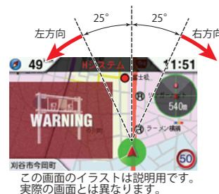
GPS警報は、ターゲットが進行方向に対して、右手または左手方向に約25°以上のとき、「左方向」または「右方向」のボイスを付加して、その方向をお知らせします。
