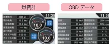
OBID II アダプター (OBID12-M) を使用していない場合、トンネル内など GPS 電波を受信できない場所では速度情報を得ることができません。ご使用いただくことで、GPS 電波を受信できなくても速度情報を得て、速度表示や正確な警告を行うことができます。
