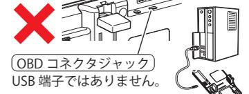
● 電源直結コードまたはシガープラグコードとOBD II アダプター (OBD12-M) の両方を同時に接続すると、本機の過熱や故障の原因となりますので、同時に接続しないでください。
