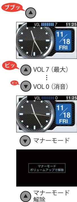
リモコンの[▲]ボタンおよび[▼]ボタンで音量を調整できます。『ピッ』という確認音で音量を確認してください。
