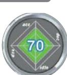
エコドライブモニターを表示します。中央の数字はポイントです。ポイントの上下により、数秒間グラフの色が変化し、数字が減点します。
