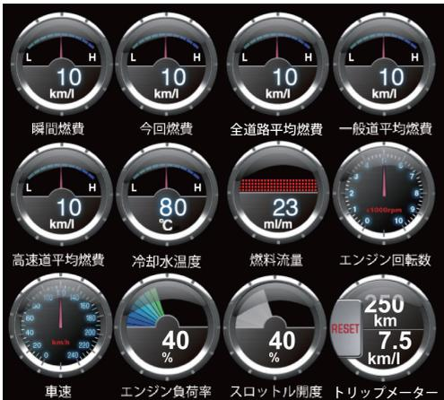
初期設定では、マルチメーターには「瞬間燃費」、「全道路平均燃費」、「トリップメーター」が表示されています。これを左図の12種類のメーターの中から選択し、表示を変更することができます。「瞬間燃費」、「今回燃費」、「全道路平均燃費」、「一般道平均燃費」、「高速道平均燃費」、「冷却水温度計」のメーターは、上段にアナログ表示、下段にデジタル表示が連動して表示されます。
