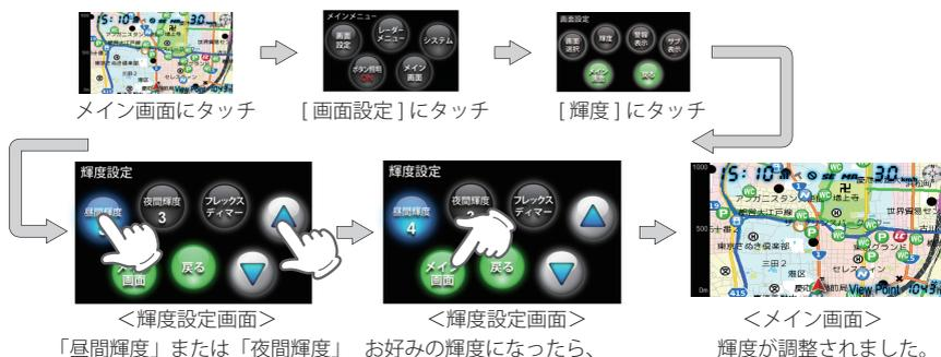
「昼間輝度」または「夜間輝度」にタッチし、上下のボタンで調整します。調整に合わせて画面輝度が変わります。
