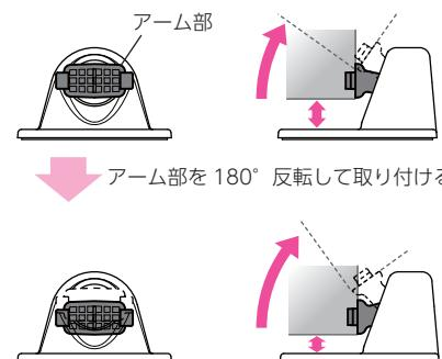
ダッシュボード取り付け用ブラケットは、アーム部の取り付け向きを180度変えることで、本機の取り付け高さを抑えることができます。
