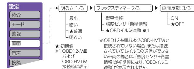
※OBD12-MⅢおよびOBD-HVTMで接続されていない場合、または接続されていてもイルミの通信ができない車両の場合は、「照度センサ+衛星情報」が初期値になり、「OBDイルミ連動」が表示されません。
