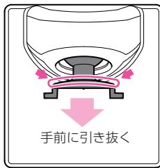
アーム部のツバの部分を布などで保護し、手前に引き抜きます。ラジオペンチなどを使用すると、簡単に抜けます。爪部を掴むと爪が折れる場合があります。
