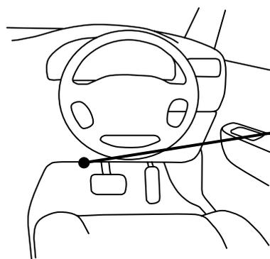
ステアリング左下に故障診断コネクタがあり、故障診断コネクタの通信線にSIM-001の配線を接続します。
