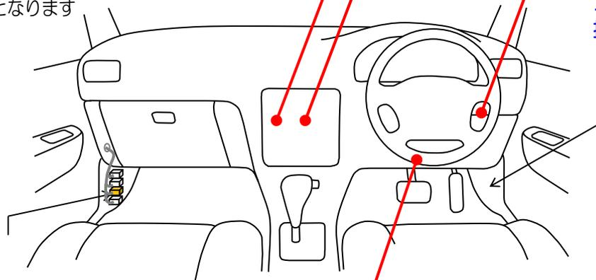
本機でドアロック/アンロック操作を使用する場合の接続先
