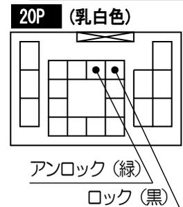
**接続先 3** (フットブレーキスイッチ) **コネクタC (7Pin) を接続します。**
