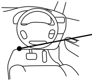
ステアリング左下に故障診断コネクタがあり、故障診断コネクタの通信線にJ-198の赤/青線、白/青線を接続します。
