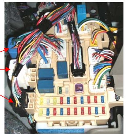
L端子を接続する場合、足元ヒューズボックス部（エンジンルーム側）に中継コネクタが3つ、ヒューズボックスに付いています。その中継ケーブルをヒューズボックスから外すと手を入れるスペースができて作業が行えます。なお、側面のコネクタを外す時、コネクタは直接目視できません。
