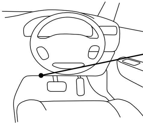
ステアリング左下にある故障診断コネクタがあり、故障診断コネクタの通信線にJ-94を接続します。
