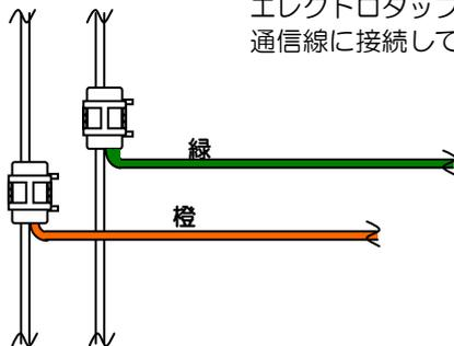
J-94 白色2P（緑線・橙線）のコネクタ部を切断し、エレクトロタップを使用して車両故障診断コネクタの通信線に接続してください。
