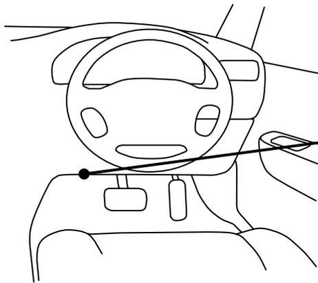
ステアリング左下に故障診断コネクタがあり、故障診断コネクタの通信線にJ-94を接続します。
