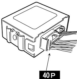
**バッテリーを接続したままカプラーの抜き差しを行うと、ECUが故障します。必ずバッテリーを外し、2～3分放置してから作業を行ってください。**
