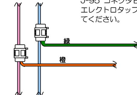
白色2Pメス 空きコネクタが見つからない場合、車両の故障診断コネクタへ接続することも可能です。J-95 コネクタB (2P 緑線・橙線) のコネクタ部を切断し、エレクトロタップを使用して故障診断コネクタの通信線に接続してください。
