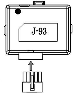
エンジンスターターのセンサーコネクタに挿入します。
