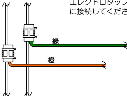
J-93 白色 2P（緑線・橙線）のコネクタ部を切断し、エレクトロタップを使用して車両診断コネクタの通信線に接続してください。
