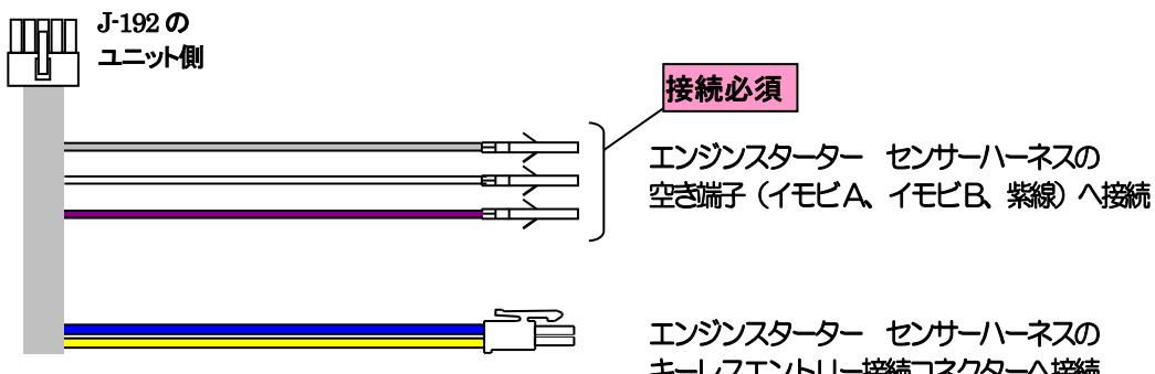
\* 接続を行うと、エンジンスターターのドアロック機能(ドアロック/アンロック操作)がご使用できます
