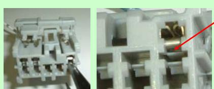
端子とツメの間(赤線部分)に、先の細いピンセットなどを差し込むと端子のロックが外れます
